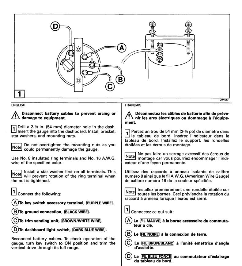
Connectez à nouveau les câbles de batterie. Afin de vérifier le fonctionnement de l'indicateur tournez le commutateur à clé à la position CONTACT et compenser l'embase à son rayon complet.
